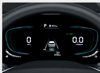
Cluster a cristalli liquidi con display LCD da 4,2"
